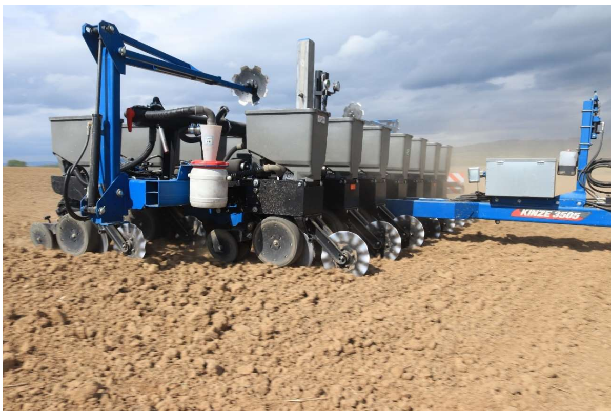
Pokus byl založen přesným secím strojem Kinze 3505 8R Interplant s výsevním ústrojím True Speed. Toto výsevní ústrojí je konstruováno pro pracovní rychlosti až 19 km/hod s přesností setí 99 %.
