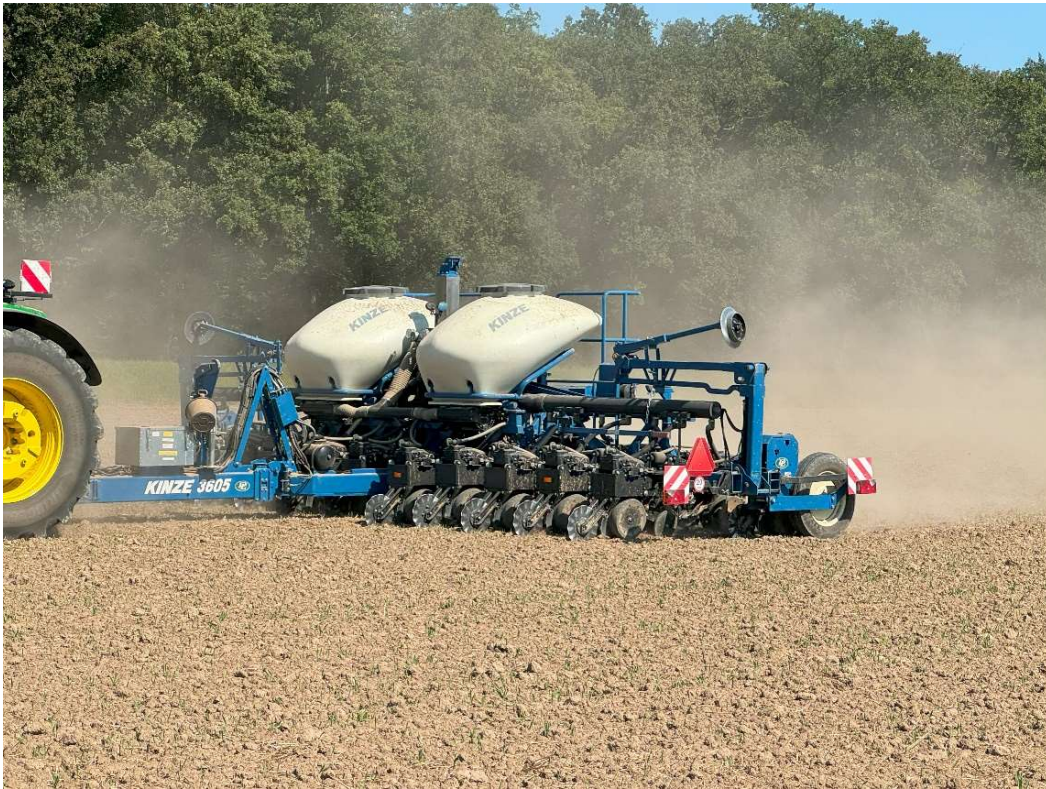
Varianta stroje Kinze 3605 12R ASD Interplant. Pracovní záběr 9 m, rozteč 75/37,5 cm.
