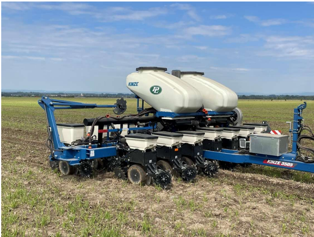
Varianta stroje Kinze 3505 8R ASD Interplant. Pracovní záběr 6 m, rozteč 75/37,5 cm.
