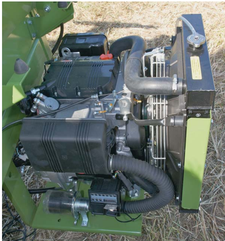
ELHO Tube 2020 ACI je vybavena dieslovým motorem Lombardini o výkonu 16 k
