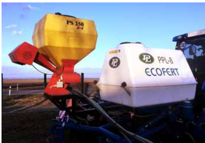
Kultivátor PPL vybavený secím strojem
