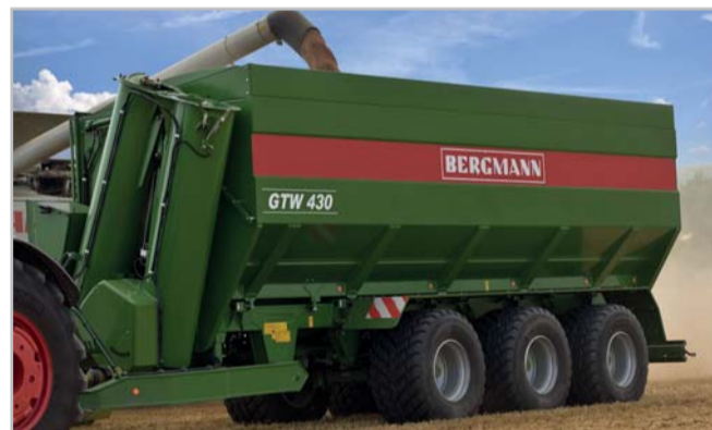
Nové překládací vozy BERGMANN se pyšní překládacím výkonem okolo 1100 t/h = vyprázdnění zásobníku 43 m 3 za minutu a 40 sekund
