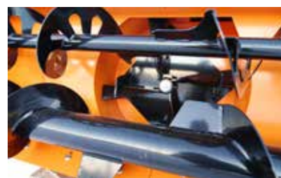
Těleso rotoru vyrobené ze speciální oceli Hardox 450.
