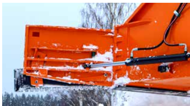
Lopata Trejon Optimal má hydraulické boční klapky, které lze sklopit o 75 stupňů dopředu a 90 stupňů dozadu. Klapky jsou opatřeny ořezovou ocelí kopírující povrch.
