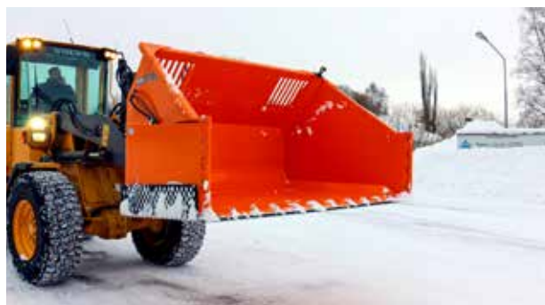
Odklízeč lopata dokáže pojmout velké množství sněhu. Lopata má kónický tvar se zaoblenou zadní hranou pro snazší vyprázdnění.
