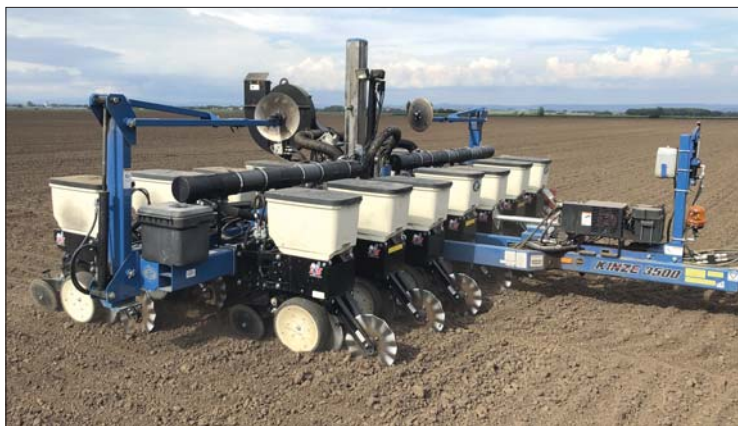
Přesný secí stroj Kinze 3500 8R Interplant při setí řepky. Změna rozteče řádků ze 75 cm na 37,5 a zpět je snadná a obsluze na poli zabere maximálně deset minut. Stroj je možné vybavit jak kapalným, tak i granulovaným přihnojením
