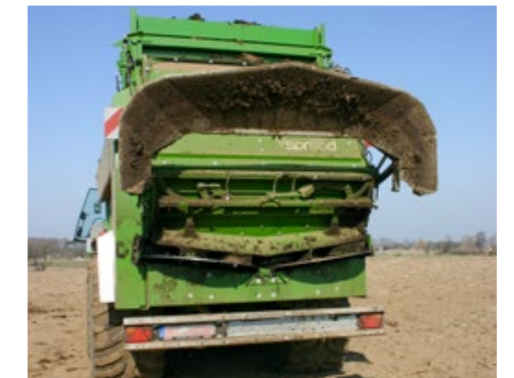
Rozmetací ústrojí V-Spread s průměrem rozmetacích talířů 1.100 mm a šesti rozmetacími lopatkami.
