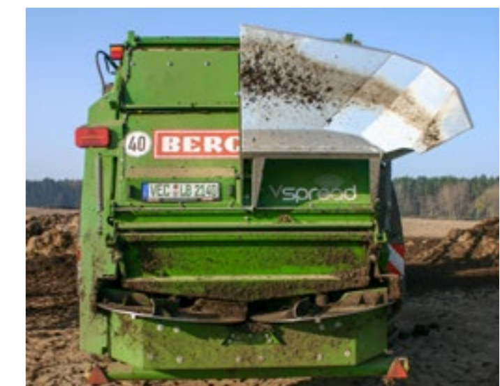
Rozmetací ústrojí V-Spread s průměrem rozmetacích talířů 1.000 mm a čtyřmi rozmetacími lopatkami.
