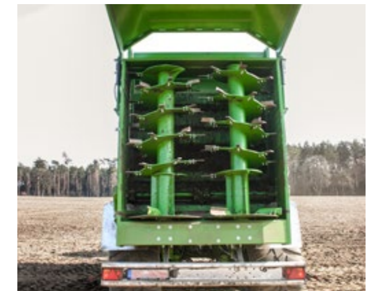
Rozmetací ústrojí 2-Spread se dvěma stojícími válci.
