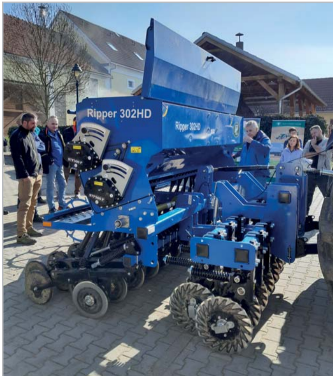
Výsevní drážku připravují zvlhčené kotouče – koltry, výsev je prováděn dvoukotoučovými botkami, výsevní drážku uzavírá zamačkávací kolečko. Mechanické výsevní ústrojí je dvojitě, což přináší možnost současného setí dvou druhů plodin Foto Luboš Stehno
