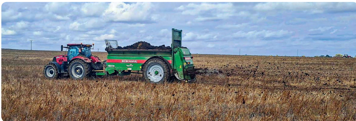
Model TSW 2140 je jednorázové univerzální nízkopodlažní rozmetadlo s kónickou celocelovou vanou o objemu 14 m 3
