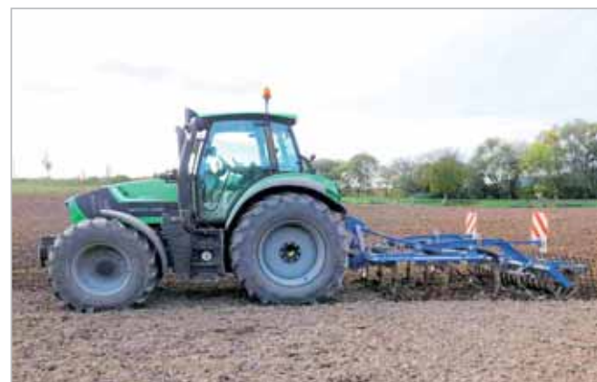
Nesený radličkový kypřič Köckerling Trio 300 nachází univerzální využití – jak pro mělké celoplošné zpracování půdy v hloubce již od pěti centimetrů, tak i pro hlubší kypření až do 30 centimetrů Foto archiv
