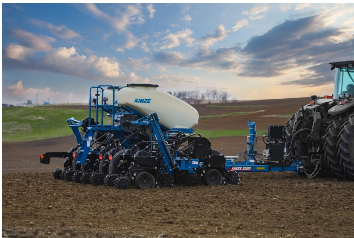
Ilustrační foto stroje Kinze 3505 8R ASD Interplant pro úzkořádkové přesné setí na 75/37,5 cm.
