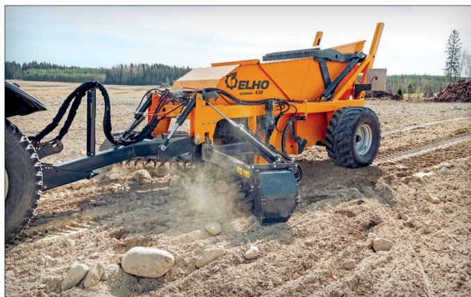
Při pracovní rychlosti 1 až 7 km/h a pracovní hloubce 0 až 7 cm dokáže sbírat kameny o velikosti 25 až 400 mm
