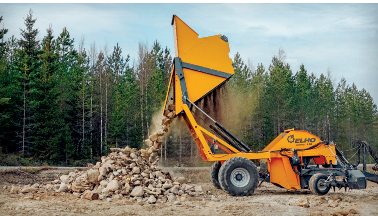
Zásobník, který pojme 1,5 až 2,0 m 3 kamenů, disponuje velkou vyklápací výškou 2,4 m
