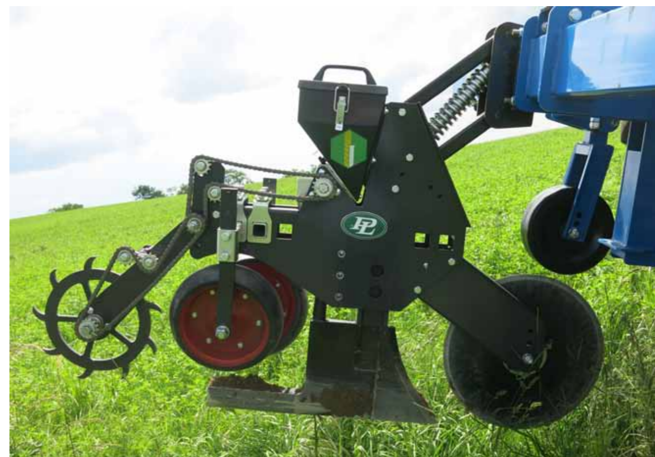
Obr. 3: Zařízení pro pokládání návnady na hraboše vytvářející podpovrchovou dutinu nebo částečně uzavřenou rýhu.
