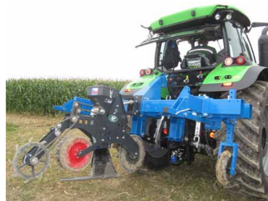
Obr. 4: Zařízení pro pokládání návnady na hraboše vytvářející podpovrchovou noru.
