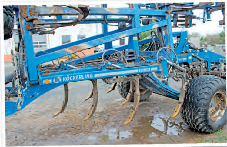
Radličky jsou rozloženy ve čtyřech řadách symetricky tak, aby docházelo k účinnému postupnému rozpracování půdy
