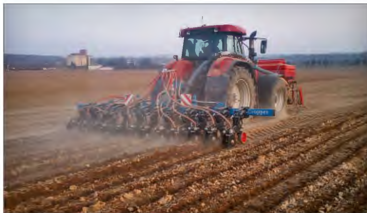
Obr. 3 – Kombinace kultivátoru pro zonální předseťovou přípravu s přihnojením tuhými hnojivy
