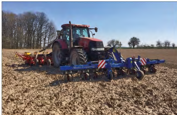
Obr. 4 – Souprava pro pásovou předseťovou přípravu se současným setím
