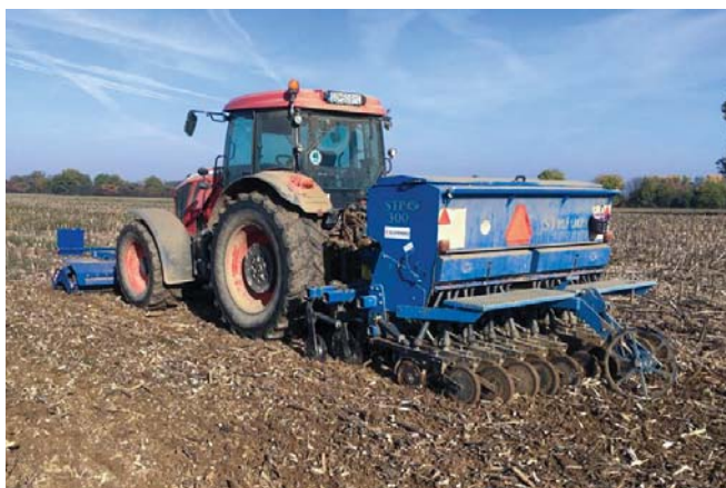
Sejačka STP 300 agregovaná s nožovým valcom pri sejbe pšenice do strniska slnečnice.
