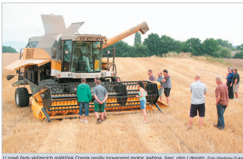
U nové řady sklízecích mlátiček Comia prošly inovacemi motor, kabina, šasi, rám i design Foto Vladislav Fuka
