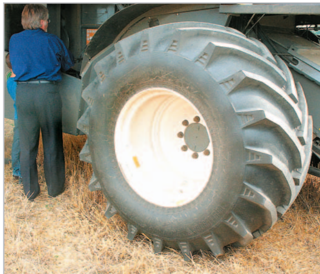
Mlátičky Comia lze vybavit pneumatikami širokými 800 mm
