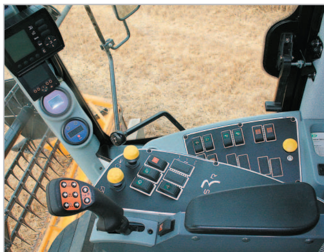
Pohled do kabiny s novými systémy v základní výbavě včetně nového joysticku v pravé loketní opěrce
