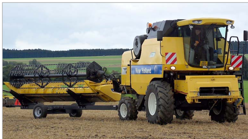
Pro přesuny sklízecích mlátiček na pozemních komunikacích se dodávají různá provedení vozíků pro přepravu žacích válu Foto Filip Javorek
