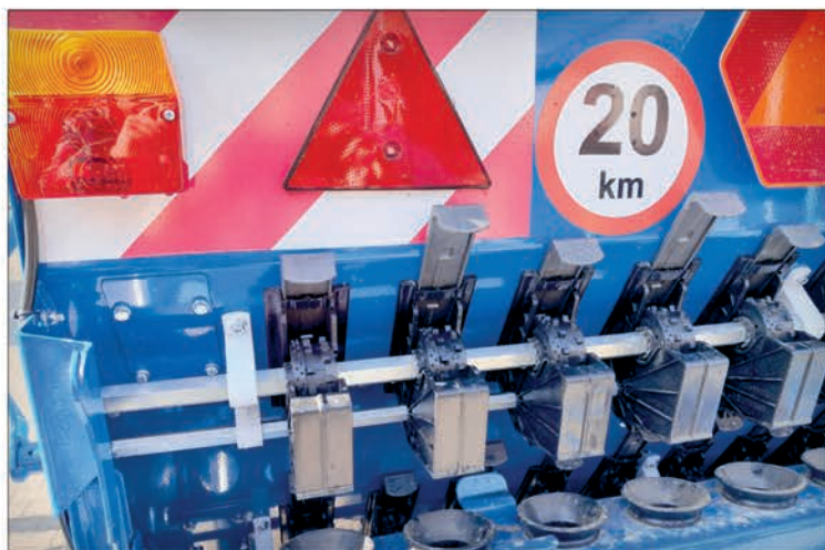
Mechanické výsevní ústrojí je tvořeno dvěma výsevními válečky (pro malé i velké osivo s výsevkem nastavitelným od 1 do 450 kg/ha)
