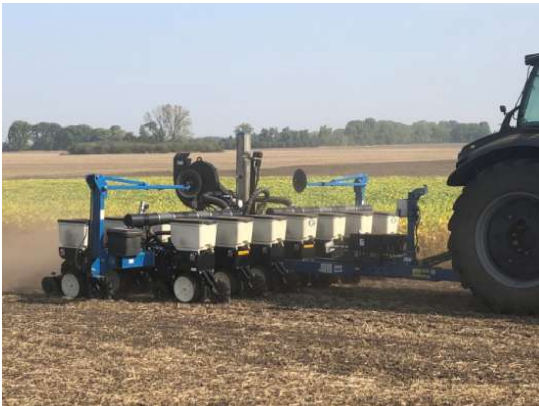
Přesný secí stroj Kinze 3500 8R Interplant, který seje jak na rozteč 75 cm, tak na 37,5 cm.
