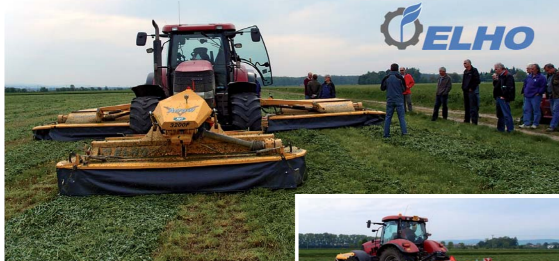
Žací stroje nové generace ELHO Arrow mají žací lišty modulové konstrukce, středové uchycení a hydropneumatické odlehčení.
