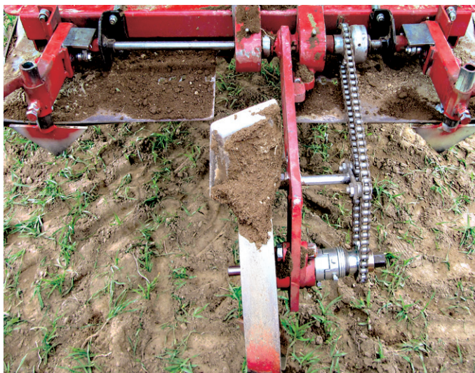
Obr. 4: Zařízení na důlkování a vytváření přerušova- ného žlábků na vrcholu hrůbky
