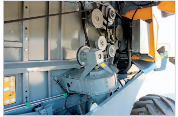
Na levé straně sklízecí mlátičky jako by chyběla část pohonů. Na snímku je vidět domlaceč, který u modelu C8 vyhazuje domláčený materiál zpět na horní síto Foto Luboš Stehno
