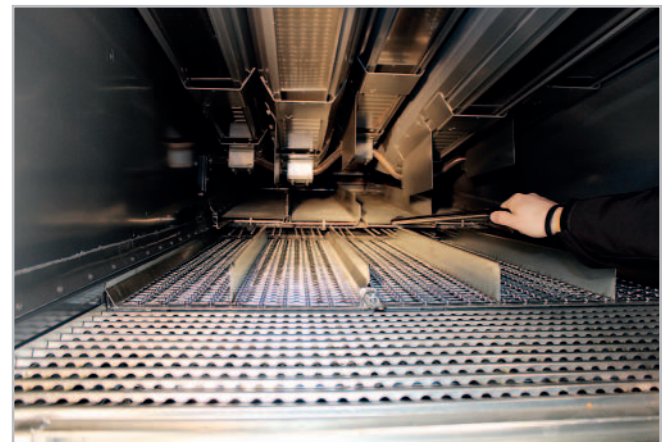
Žaluziová síta jsou u modelu C8 mechanicky stavitelná, pomocí dodávané páky lze vyjmout i segmenty vynášecí desky Foto Luboš Stehno
