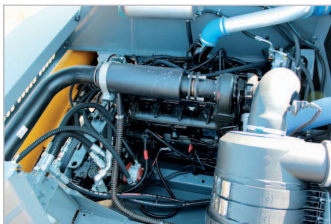
Pohonnou jednotkou modelu C8 je šestiválec Agco Power s výkonem 210 k, provedení na snímku je ještě bez systému SCR. Nově vyráběné kombajny již tento prvek snižující emise ve výfukových plynech obsahují Foto Luboš Stehno
