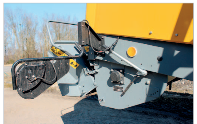
Otočením páky se překlápí usměrňovací clona, která směřuje proud slámy do drtiče, nebo mimo něj Foto Luboš Stehno
