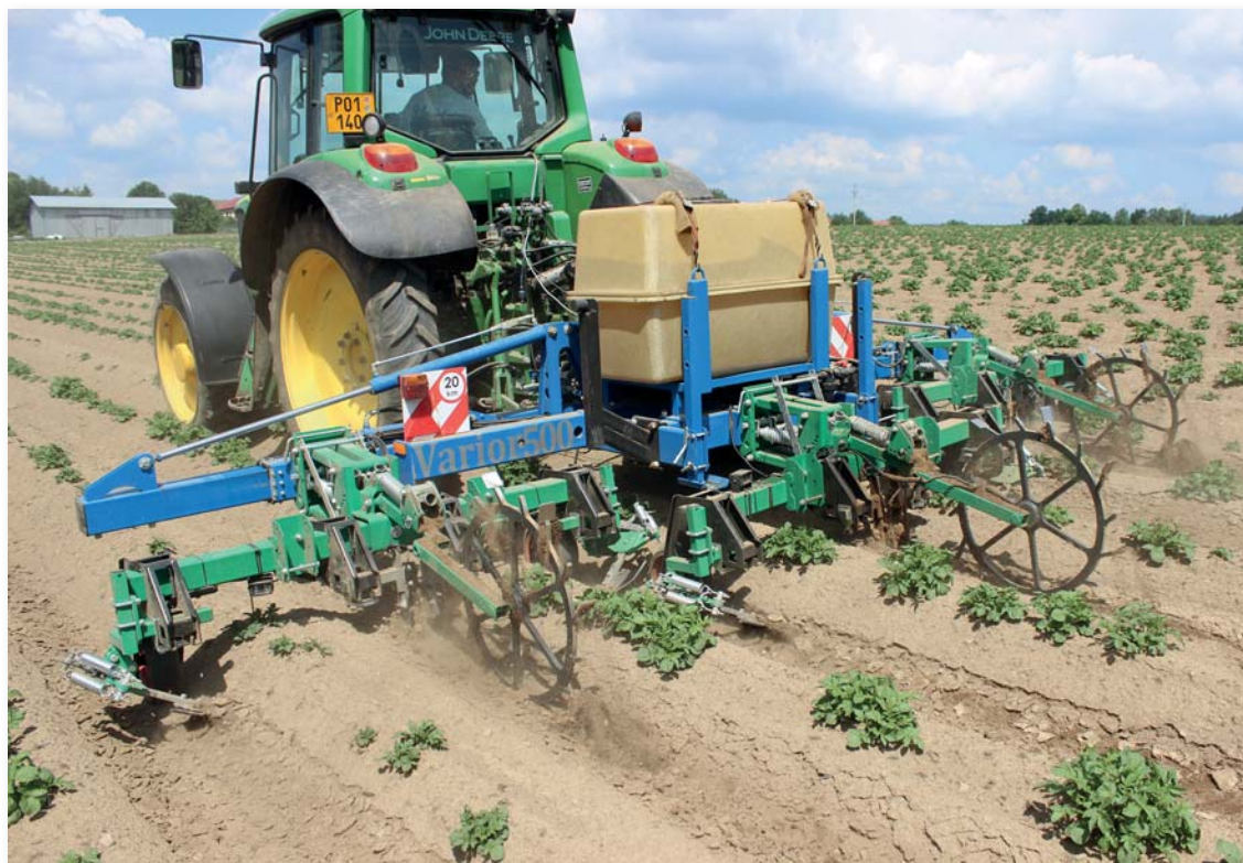
► Kypřič Varior 500 s odmontovanými hvězdicovými válci při přihnojování kapalným dusíkatým hnojivem DAM pomocí aplikačních nožů směřujících z úpatí nekolejové brázdě do kořenové zóny brambor s následným vytvořením důlků a hrázek v brázdě
