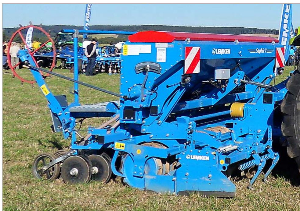
Sít se může různými typy secích kombinací, například tvořených rotačními branami a mechanickým secím strojem Foto Filip Javorek
