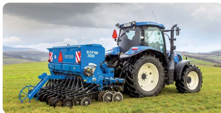
Secí kombinace Ripper STP 300 je vybavena zásobníkem o objemu 850 l a 19 výsevními jednotkami
