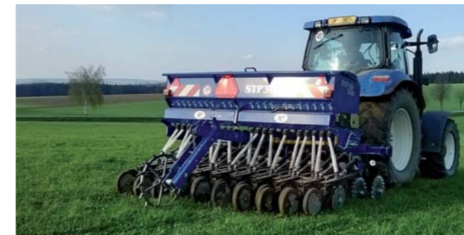
Souprava traktoru výkonové řady nad 100 Hp. spolu se secím strojem STP 300 je velice kompaktní a snadno se pohybuje i na svažitých a složitě dostupných místech luk a pastvin
