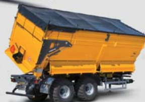
PRC-2HP/W18WB 18 TUN TRAKTOROVÝ NÁVĚS DVOJSTRANNĚ SKLÁPĚNÝ
