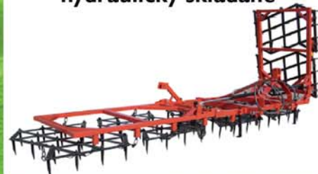
Polní hřebové brány hydraulicky skládané
