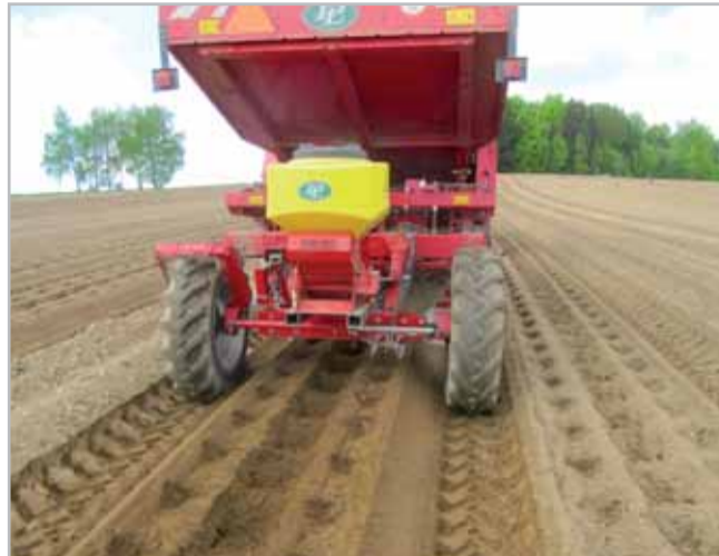
Obr. 2 – sázení brambor s důlkováním a přívěsem pomocné plodiny do kolejové brázd Foto archiv autorů
