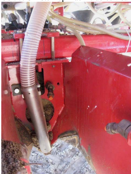
Obr. 7: Umístění aplikační trubice v sázecí radlici pro aplikaci hnojiva pod hlízu
