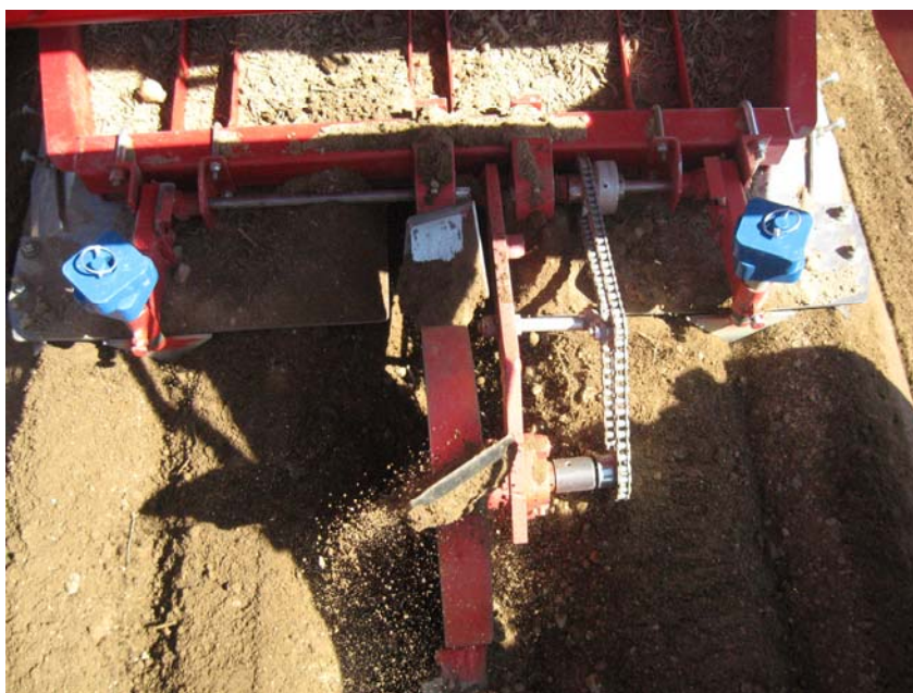
Obr. 6: Důlkování nekolejové brázdy a vytváření vsakovacího žlábků na vrcholu hrůbku
