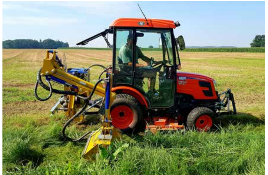
Kioti s předsunutým příkopovým ramenem Marolin M290 APS
