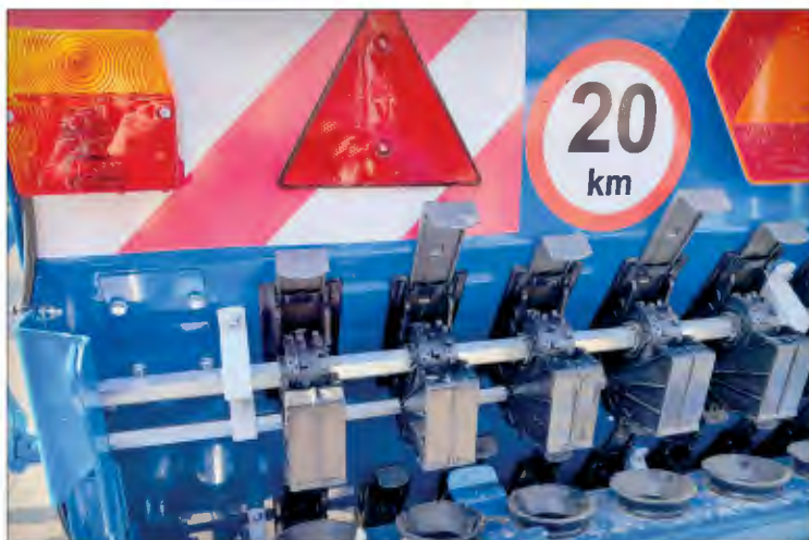
Mechanické výsevní ústrojí je tvořeno dvěma výsevními válečky (pro malé i velké osivo s výsevkiem nastavitelným od 1 do 450 kg/ha)
