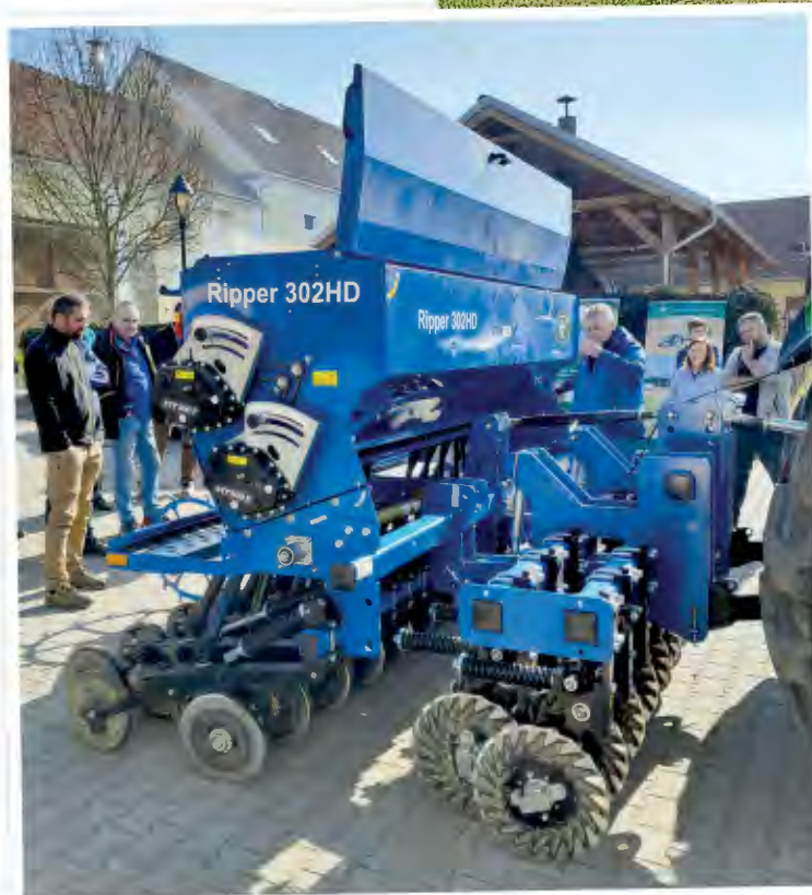
Výsevní drážku připravují zvlněné kotouče – koltry, výsev je prováděn dvoukotoučovými botkami, výsevní drážku uzavírá zamačkávací kolečko
