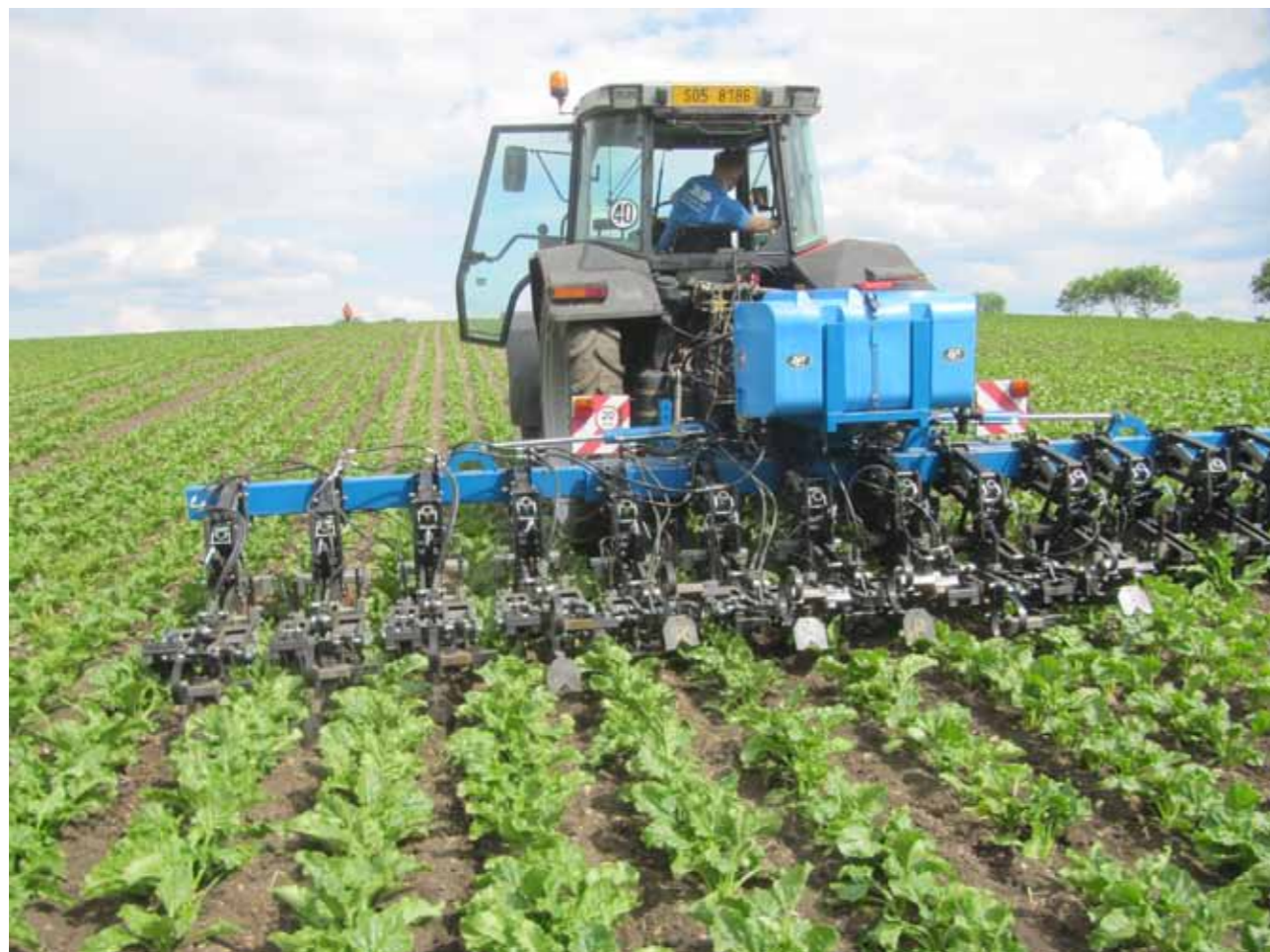
▲ Obr. 1 Plečkování cukrovky s přihnojením a důlkováním.
