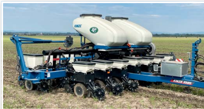
Foto 2 – Přesný secí stroj Kinze 3505 8R Interplant pro setí s roztečí 75 nebo 37,5 cm. Změna rozteče řádků je snadná, provádí se na pozemku a zabere maximálně deset minut. Setí řepky ZD Dolany 2023
