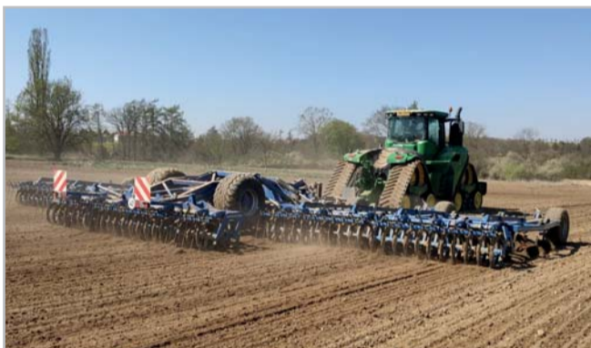
Allrounder s pracovním záběrem 14,5 m dokáže za den připravit 140 ha půdy Foto archiv P & L
