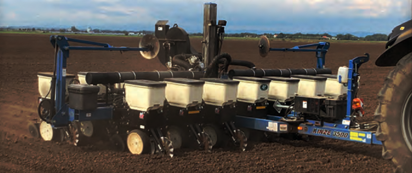
Obr. 4 – Secí stroj Kinze 3500 Interplant je vybaven technologií variabilního setí. Změna rozteče řádků je snadná a nepřesáhne deset minut. Všechny pokusy uvedené v tomto článku byly založeny tímto strojem
