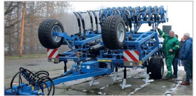
Současné Quadro má upravenou konstrukci, radličky z tvrdokovu Betek s větším řezacím efektem a zadní dvojitý STS válec Foto Jiří Hruška
