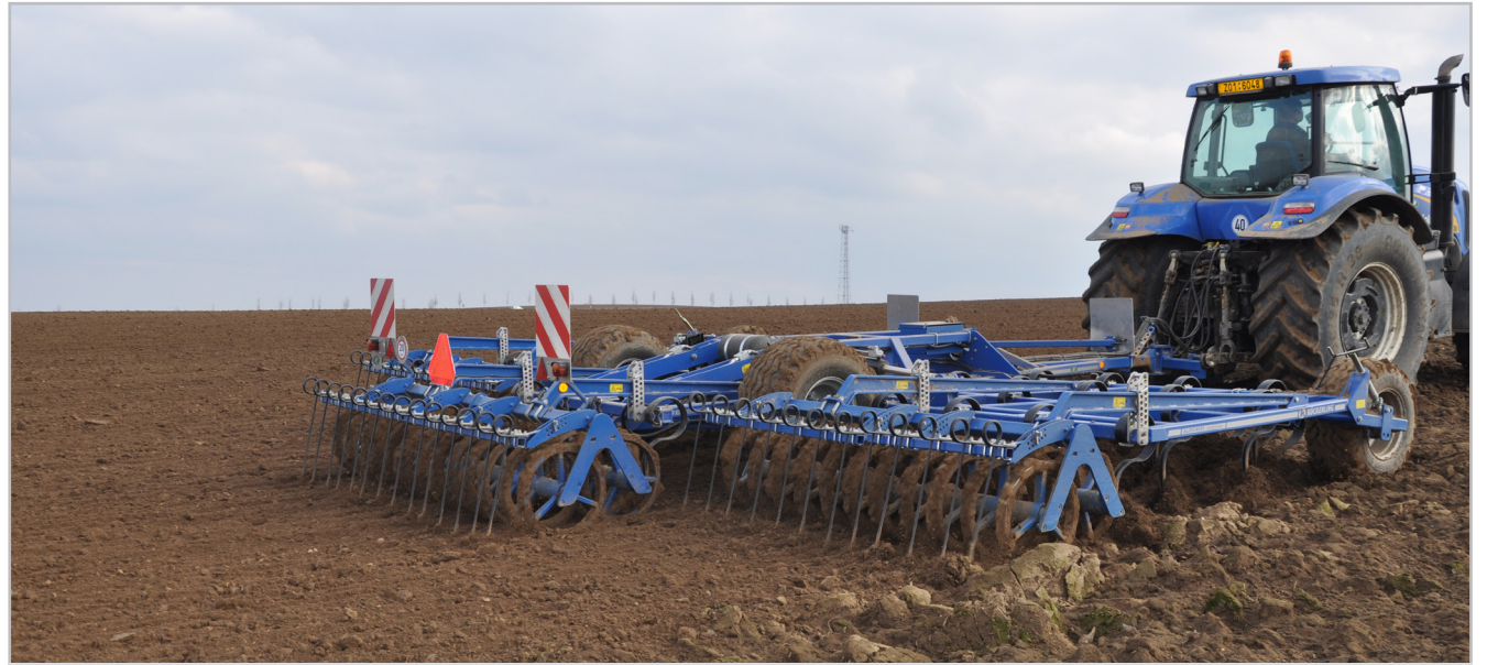
Kombinátor Allrounder je stroj určený pro zpracování půdy a vytvoření seťového lůžka při finální jízdě před setím
