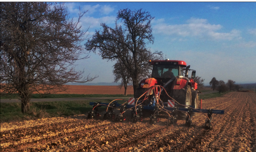
Obr. 8 – Tvorba pásů v rámci přípravy na setí kukuřice
