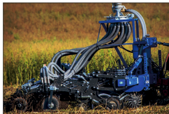
Pohled na Muck Tiller při pásovém zpracování půdy
