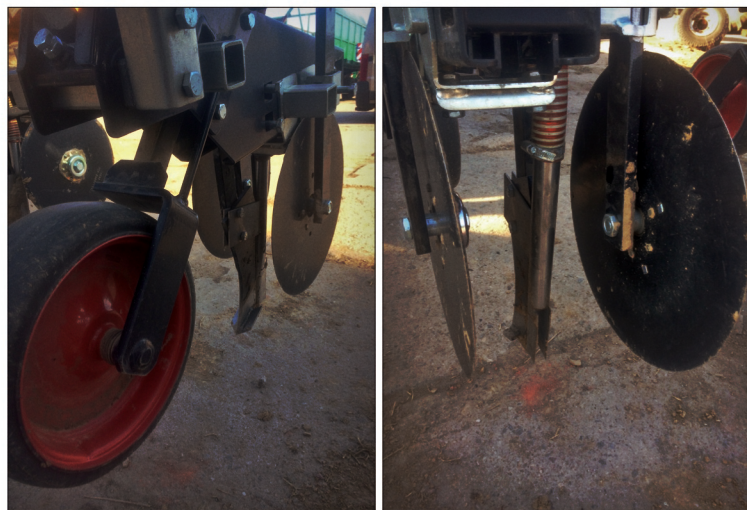
Obr. 7 – Detail pracovního nástroje kypřiče pro pásové zpracování půdy a aplikaci hnojiva
