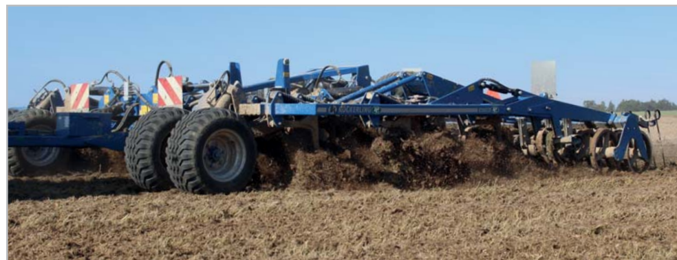
Vector je radličkový kypřič vhodný jak pro mělké zpracování půdy, tak pro hluboké kypření
