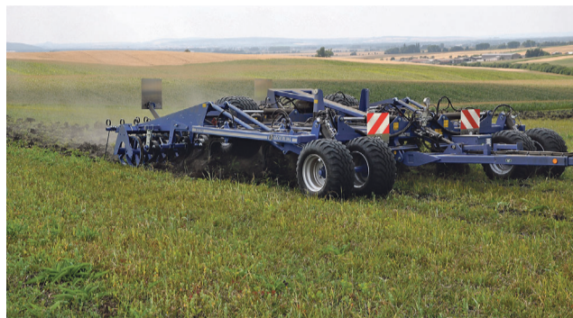
Köckerling Vector 460 při zpracování těžké půdy na hloubku 25 cm po předplodně v Míškovicích.
