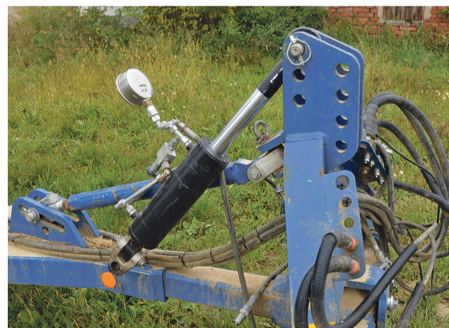
Zesilovač tahu zlepšuje kvalitu práce stroje.
