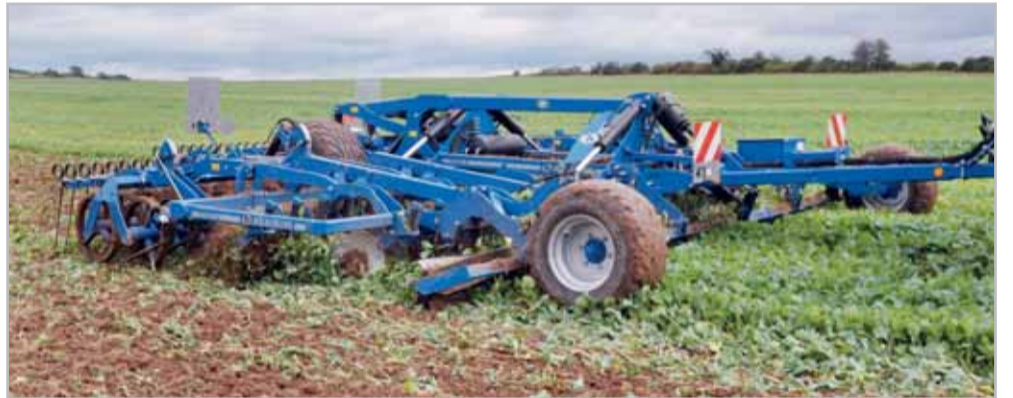
Rebell classic 600T se spirálovým jištěním talířů a předním řezacím válcem při zpracování výdrolu řepky
