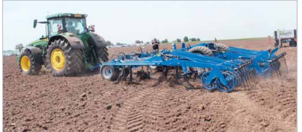
Těžký čtyřřadý radličkový kypřič Vector v pracovních záběrech od 4,6 do 9 m zapadá do systému precizního zemědělství
