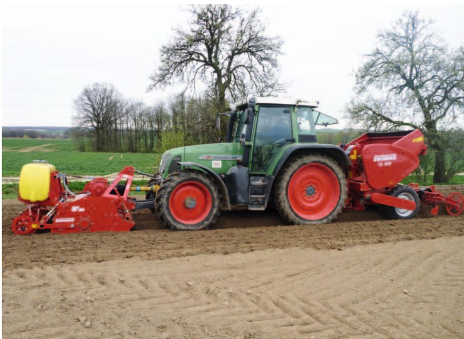
Mit der speziell abgestimmten Grimme-Frontfräse GF 180 sorgen Sie für aktive Bodenlockerung rund um die Knolle in einem Arbeitsgang.
