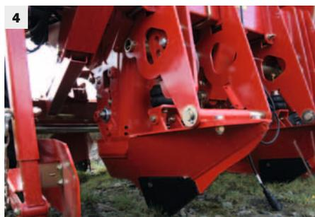
*So bleiben auch leichte Böden lange in Form: Mit den groß dimensionierten Zinken des Häufelkörpers (3) erfolgt der Dammaufbau. Die Wölbung entsteht durch eine leichte Verfestigung der Erde mit der Gitterrolle, die dennoch die raue Oberfläche beibehält.*
