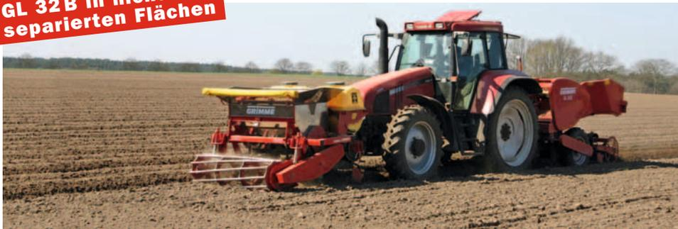
*Düngen, Legen, Dammaufbau: Mit der GL 32 B ist in einem Arbeitsgang alles erledigt – auch in nicht separierten Flächen. Im Zusammenspiel der kompakten GL 32 B und des optionalen Düngerstreuers in Frontanbau sind sehr schnelle Wendemanöver möglich. So verlieren Sie keine Zeit und profitieren von schnellen Ergebnissen.*
