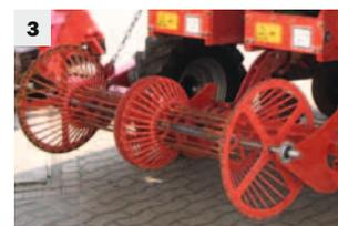
Für eine verbesserte Wasseraufnahme: Die Gitterrolle (3) wird auf leichten Böden in separierten Beeten eingesetzt.
