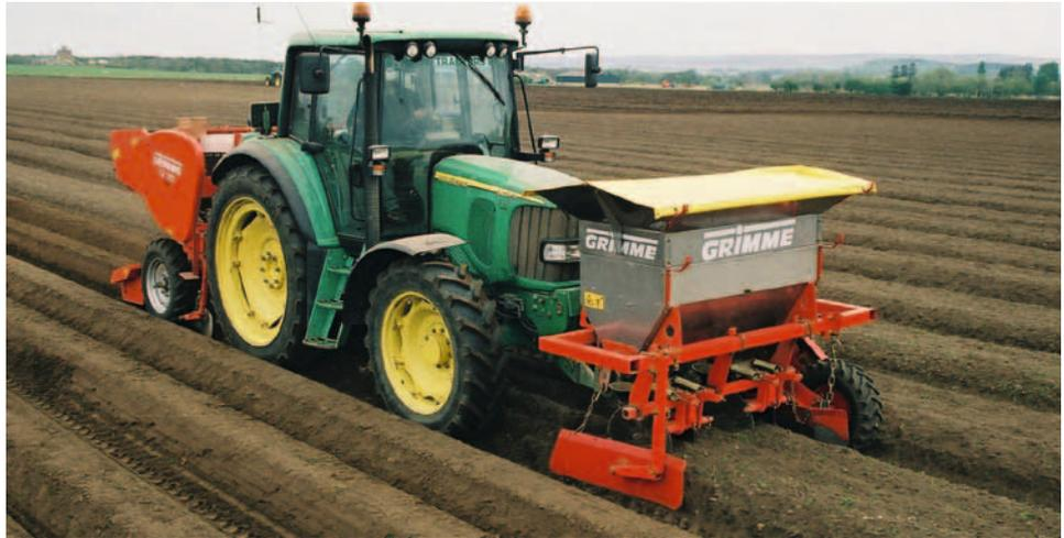
*Solide Vorarbeit: Aufgabe des Frontackengerätes ist es vor dem Schlepper die Dämme zu formen, sodass möglichst wenig Erde verdichtet wird.*
